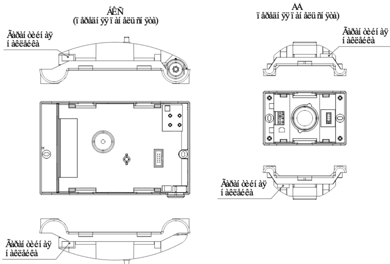
Рисунок 2 - Схема пломбировки сигнализаторов от несанкционированного доступа
